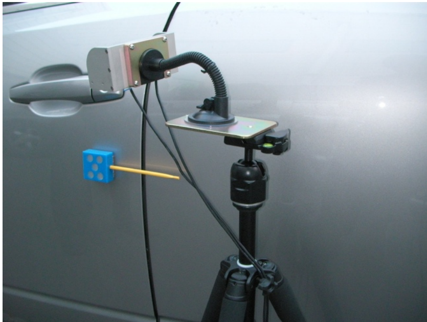
그림9. Side Door 폐속도 측정
